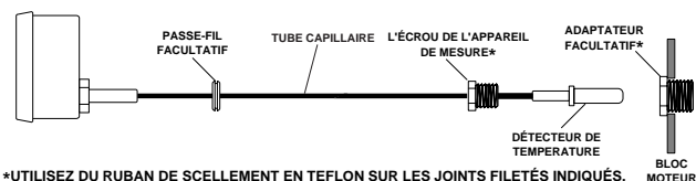
Figure 6. Raccordement de la jauge mécanique de température
